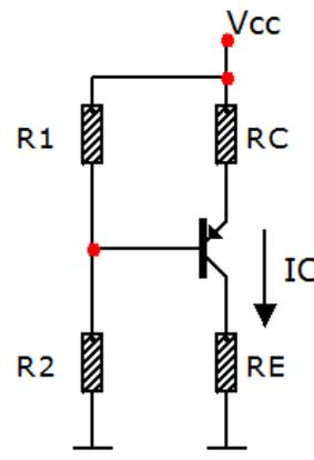
Considerando a corrente DC de base do transistor bipolar da figura acima como desprezível, que a tensão emissor-base (tensão de emissor menos tensão de base) vale 0,7 Volts, que a tensão Vcc vale 6 Volts, que os resistores R1, R2, RC e RE valem, respectivamente, 10000 Ohms, 20000 Ohms, 1000 Ohms e 1000 Ohms, então, a corrente de coletor IC e a tensão VCE (tensão de coletor menos tensão de emissor), nessa ordem, valem aproximadamente:
