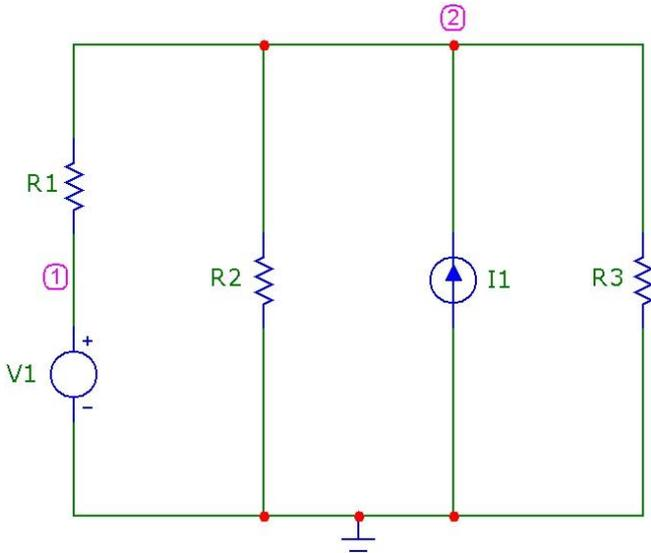
Na resistência  $R_3$ , a tensão, a corrente e a potência dissipada, nessa ordem, valem aproximadamente:
