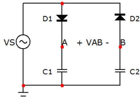
No circuito da figura acima, a tensão  $V_S$  senoidal de frequência é igual a 60 Hertz, o valor RMS igual a 10 Volts e o valor médio igual a zero Volts, e os diodos D1 e D2 possuem tensão de condução direta de 0,7 Volts. Considerando esse contexto, a diferença de tensão máxima entre o ponto A e B, (ou seja,  $V_{AB}$  máximo), é de aproximadamente:
