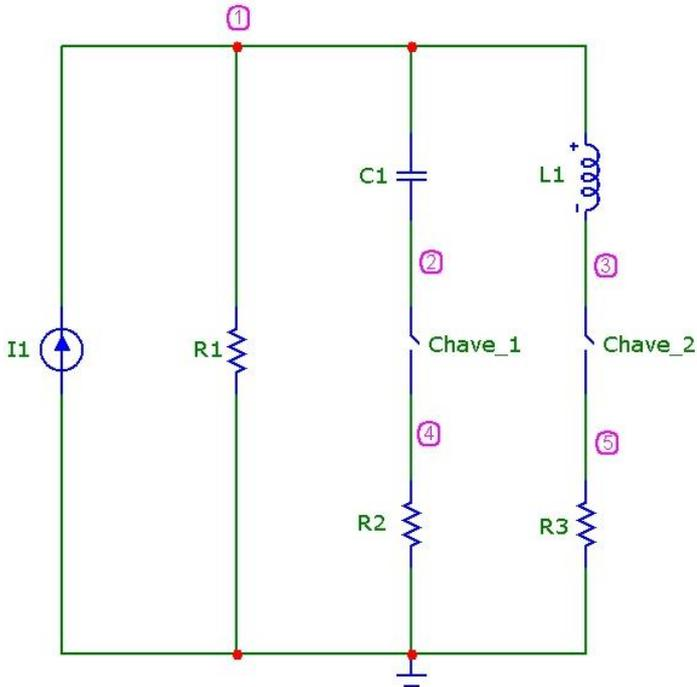
Respectivamente, em relação ao nó terra, os valores da tensão no nó "1" antes das chaves fecharem simultaneamente; da tensão no nó "1" imediatamente após as chaves fecharem simultaneamente; e da tensão no nó "1" após as chaves ficarem ambas fechadas por 100 minutos, são aproximadamente:
