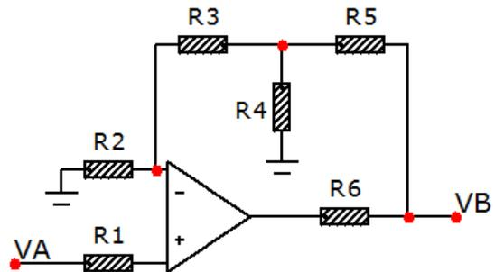
Sendo o amplificador operacional ideal, a tensão no ponto VA igual a 1,5 Volts, os resistores R1, R2, R3, R4, R5 e R6 todos iguais a 1000 Ohms, então, a tensão no ponto VB no circuito acima é de aproximadamente:
