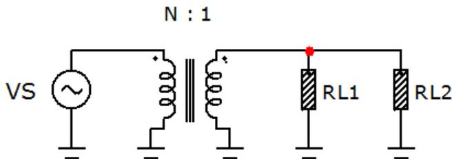
No circuito da figura acima, o transformador ideal de uma derivação é alimentado no primário com uma fonte de tensão VS senoidal de frequência igual a 60 Hertz, de valor RMS igual a 120 Volts e valor médio igual a zero Volts. A derivação alimenta uma resistência RL1 de valor 100 Ohms e uma resistência RL2 de valor 200 Ohms. Sendo a relação de transformação N igual a 5, a corrente RMS do primário fornecida pela fonte VS e a corrente RMS no resistor RL2, nessa ordem, valem aproximadamente:
